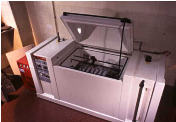
Fig. 9.13 Salt fog chamber
