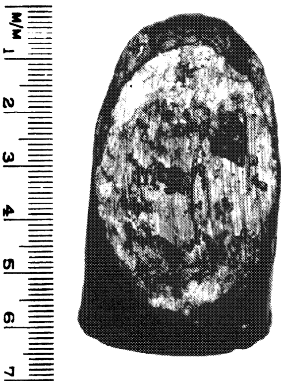
Fig. 33. Wraysbury: joint surface after shearing displacement of 5 mm in laboratory test. Wraysbury: surface d'un joint après un déplacement au cisaillement de 5 mm dans un essai de laboratoire.
