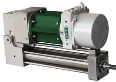
Abb. 6.6 Räumlich vollständig integrierter elektrisch-hydrostatischer Aktor mit Lebensdauer-Ölfüllung, Leistungsbereich 0,5 bis 6 kW, Vorschubgeschwindigkeit und -richtung werden durch einen elektrischen Servomotor vorgegeben [11]. (Quelle: Böhner-EH GmbH)
