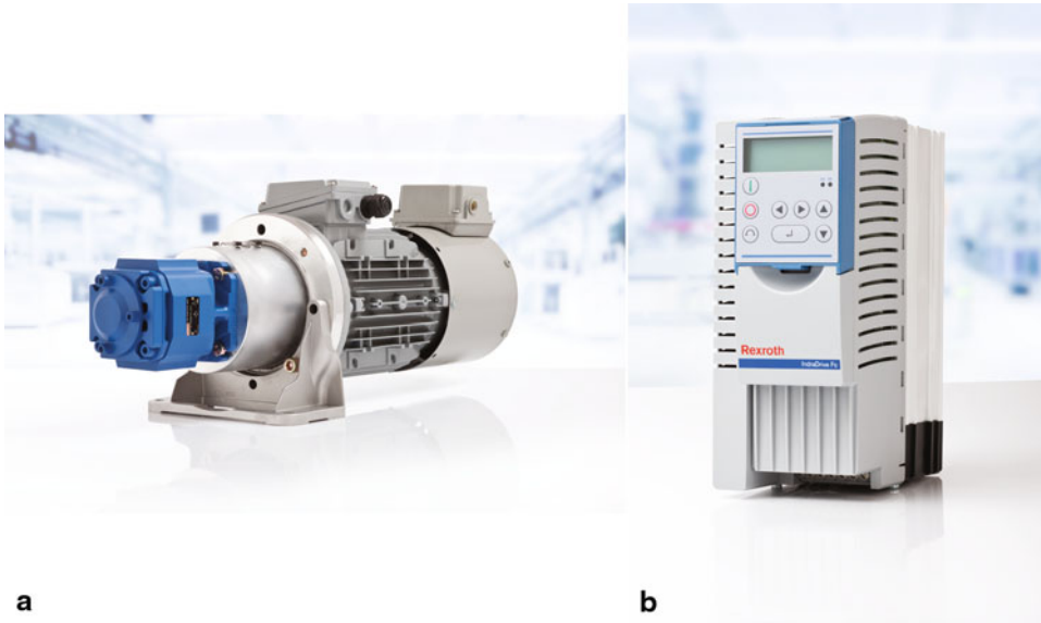
Abb. 3.61 Drehzahlvariabler Pumpenantrieb (DvP), grundlegende Ausbaustufe (FcP 5000-System, Bosch Rexroth). a Motor-Pumpen-Baugruppe, bestehend aus Asynchron-Normmotor und Innenzahnradpumpe; b Frequenzumrichter
