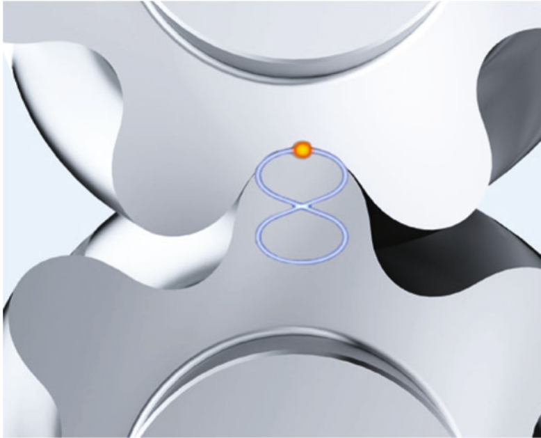
Abb. 3.20 Geräuschreduzierte Außenzahnradpumpe (AZPJ, Bosch Rexroth). Kontinuierlicher Zahnradkontakt mit Eingriffspunkten auf geschlossener Eingriffslinie
