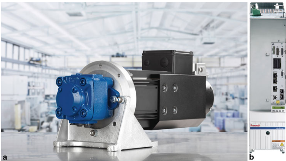
Abb. 3.62 Drehzahlvariabler Pumpenantrieb (DvP), höchste Ausbaustufe (SvP 7000-System, Bosch Rexroth). a Motor-Pumpen-Baugruppe, bestehend aus Synchron-Servomotor und Innenzahnradpumpe, b Servoumrichter
