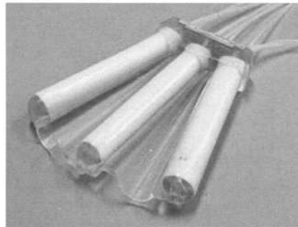
Fig.5. Active Pneumatic Actuator Fin
