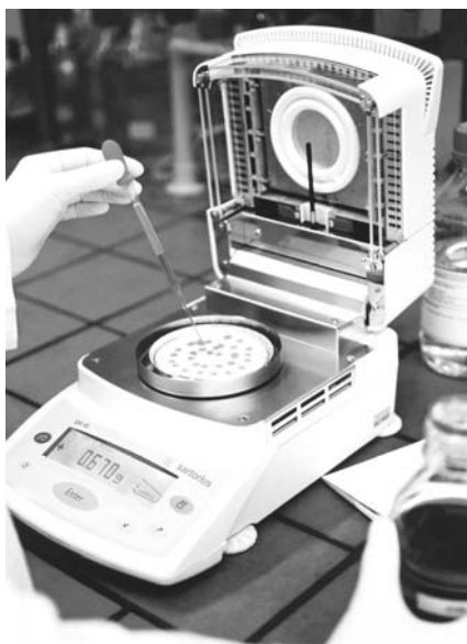
Fig. 2 Moisture analyser (photo: Sartorius)
