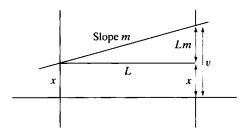
$$\begin{bmatrix} v \\ m \end{bmatrix} = \begin{bmatrix} x + Lm \\ m \end{bmatrix} = \begin{bmatrix} 1 & L \\ 0 & 1 \end{bmatrix} \begin{bmatrix} x \\ m \end{bmatrix};$$
