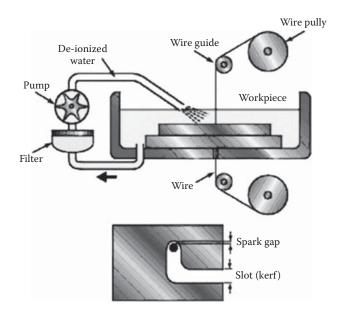
Figure 21.30 Wire electrodischarge machining (CES Edupack, 2012).
