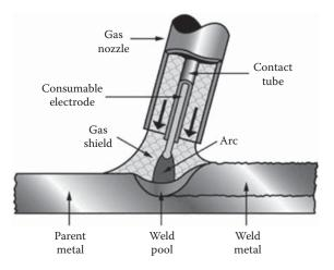
Figure 21.24 Metal inert gas welding (CES Edupack, 2012).
