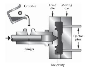
Figure 21.3 High-pressure die casting (CES Edupack, 2012).
