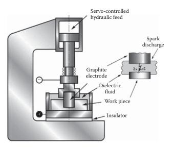
Figure 21.29 Electrodischarge machining (CES Edupack, 2012).
