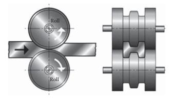
Figure 21.4 Shape rolling process (CES Edupack, 2012).
