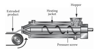
Figure 21.11 Polymer extrusion (CES Edupack, 2012).
