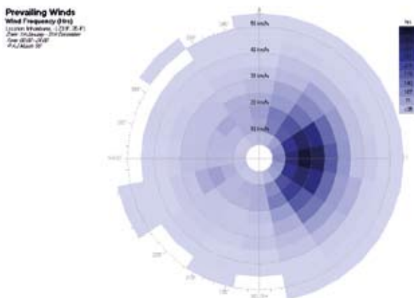
{ FIG. A1.9 } Diagrama do regime anual de ventos em Inhambane, mostrando a frequência dos ventos dominantes.
