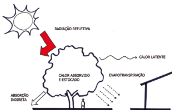
{ FIG. A4.3 } Processos de sombreamento (protecção da radiação solar) e evapotranspiração.
