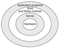
Fig. CS1.1 UNIX structure
