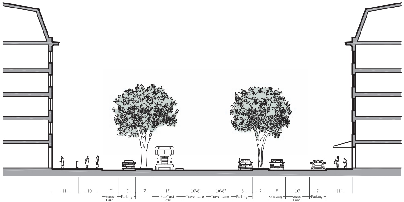
Figure 2.14: Avenue Montaigne, Paris, France. Bureau de la Voirie Parisienne, 1850. Section. © 2013 Dover, Kohl & Partners
