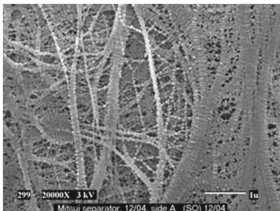
Fig. 20.5 SEM of the Mitsui separator
