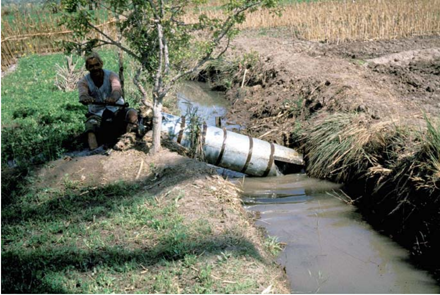
Fig. 3.7 Archimedes screw (photo courtesy of Henning Fahlbusch)
