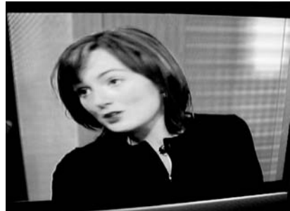
(d) One colour bit (R0) missing
