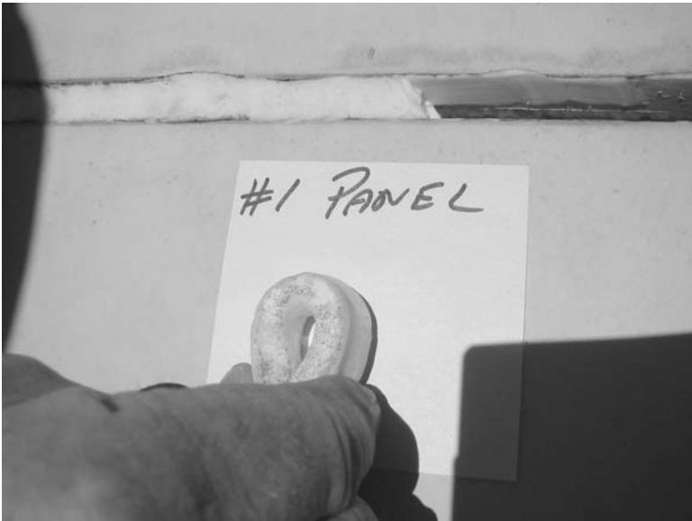
FIG. 9—180° manual bend of sealant.
